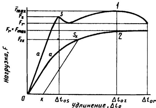
1—материал имеет предел текучести; 2—материал не имеет предела текучести; а—участки прямой начальной направления кривой в начале кривой «нагрузка—удлинение»; S—предел текучести; х—отрезок на оси удлинения для определения условного предела текучести;  $S_x$ —условный предел текучести.
